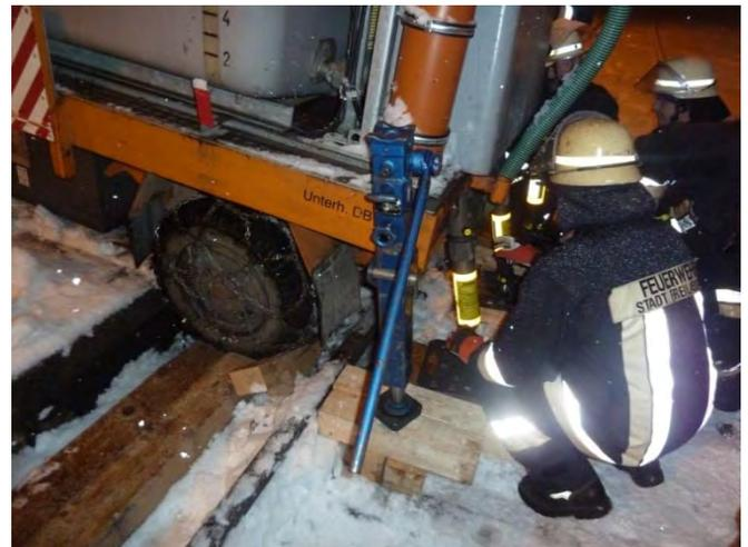
Mittels hydraulischem Hebegerät und einem speziellen Abstützsystem aus dem Rüstwagen der Feuerwehr Freilassing wurde das Fahrzeug ohne weitere Beschädigungen auf den Bahnsteig gezogen.
