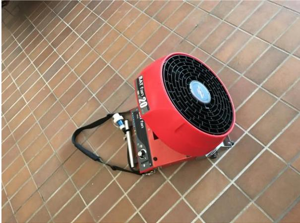
Um bei der Brandbekämpfung noch effektiver zu sein wurde ein Akkubetriebener Lüfter beschafft. Dank diesem Gerät kann der Erstangriff bei einem Brandeinsatz noch schneller erfolgen. Ein weiterer Pluspunkt ist der Abgasfreie Betrieb dieses Gerätes. Er ergänzt somit die beiden Verbrennungsmotorbetriebenen Lüfter und den Wasserbetriebenen Turbinenlüfter ideal.
