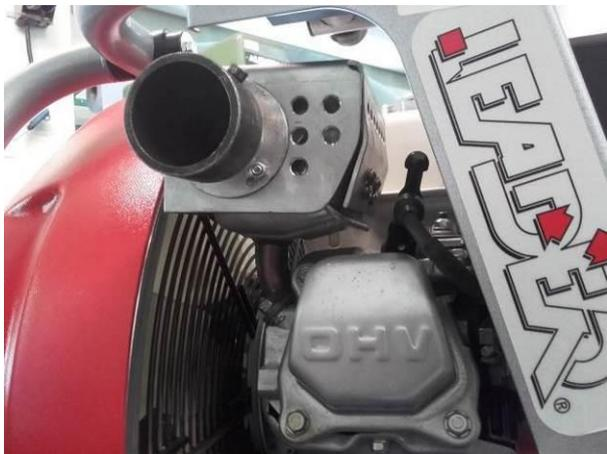
Der Hitzeschutz am Auspuffschalldämpfer der Überdrucklüfter wurde stärker dimensioniert um das Gewicht des Abgasschlauches halten zu können. Der Originalhalter ist aufgrund des Dünnen Blechs ausgerissen.
