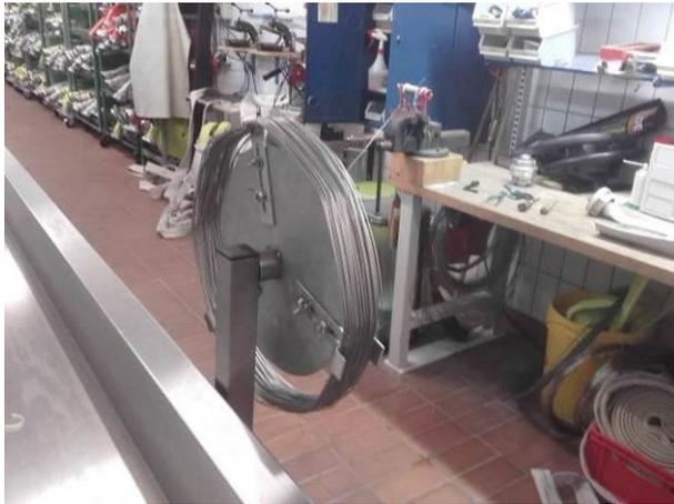
Eine kleine aber feine Sache ist der Drahtabroller für den Schlaucheinbindedraht. Der Eigenbau erleichtert das Abrollen beim bestücken des Einbindegerätes.
